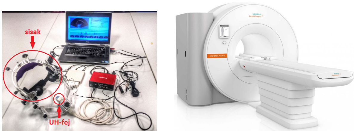
3. ábra. Dinamikus audiovizuális beszédfelvételek készítésére alkalmas UH-készülék (balra) és MRI-berendezés (jobbra). [56]
