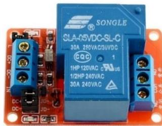
Figure A.9: 1CH Relay module 5V 30A.
