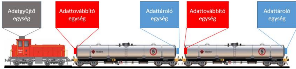
50. ábra - Vagon sorrend meghatározó rendszer felépítése
