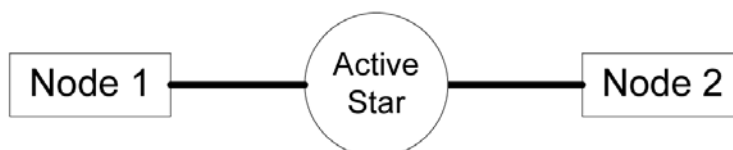
1.25. ábra: Hub felépítése
